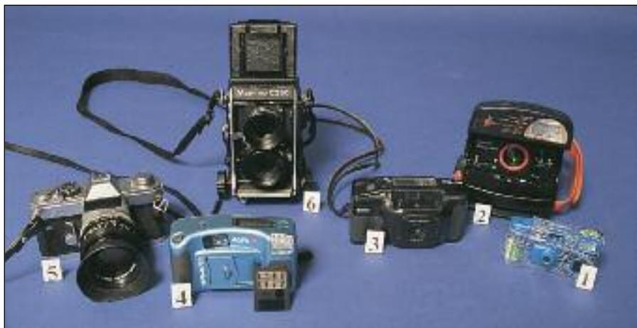
**1. Jetable - 2. Polaroid - 3. Compact - 4. Numérique - 5. Reflex - 6. Appareil 6 x 6**
